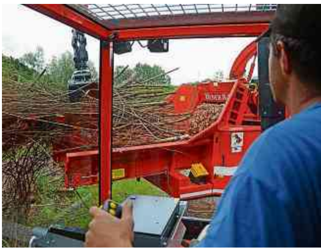
Häcksler, Kran und LKW lassen sich aus derselben Kabine bedienen.
